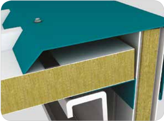
Yarım Mahya Detayı / Semi Ridge Detail
